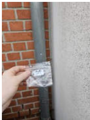
Abb. 39: PCB-haltige Fugenmasse
